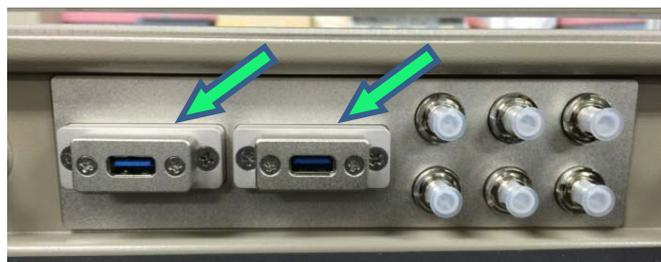
電波シールドボックス内部へ引き込みの可能なフィルタ内蔵のコネクタモジュールです。
