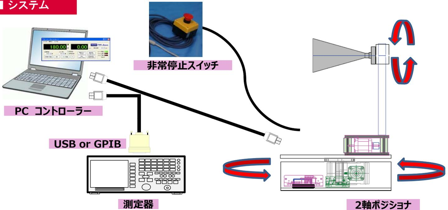
制御軸は選べます。垂直移動、水平移動、ボアサイト回転、サテライト回転
